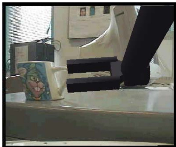
Figure 7. Pince virtuelle plongée dans un environnement réel
