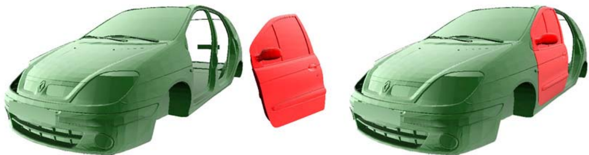
Figure II-15 Prototypage virtuel et essai de montage de véhicule automobile
