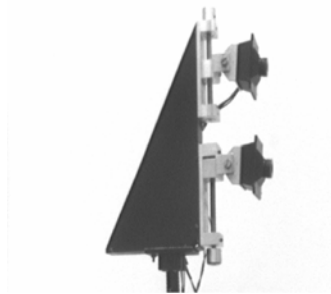
Figure I-14 Tête stéréoscopique munie de deux caméras.
