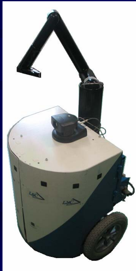
Bras embarqué sur une base mobile (ex. ARPH)
