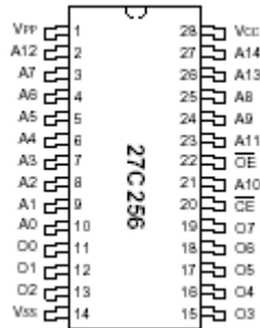
Figure I.3 : Schéma de câblage DIP de la mémoire EEPROM 27C256.
