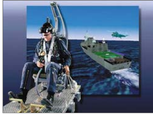
Ce simulateur est destiné à la formation des manoeuvres d'appontage d'hélicoptère pour les pilotes et les équipages des Forces canadiennes. Ses principaux composants comprennent un poste de pilotage monté sur une plate-forme de mouvement hydraulique classique à six degrés de liberté, un générateur d'images perfectionné et un afficheur à fibre optique stéréoscopique monté sur casque. © Photo avec la permission de R&D pour la défense Canada-Toronto
