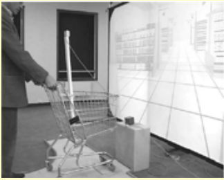
Interfaçage comportemental par chariot instrumenté pour les déplacements dans le magasin © ENSMP
