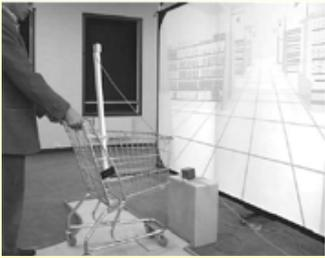
Interfaçage comportemental par chariot instrumenté pour les déplacements dans le magasin © ENSMP
